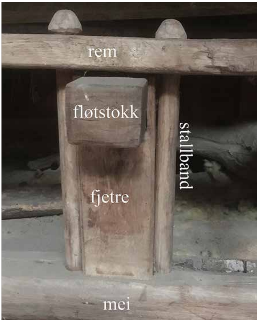
Detalj på ein slede med mei nede og rem oppe. I 1000 år har stallbanda (dei to runde pinne) halde sledane saman på denne måten.
