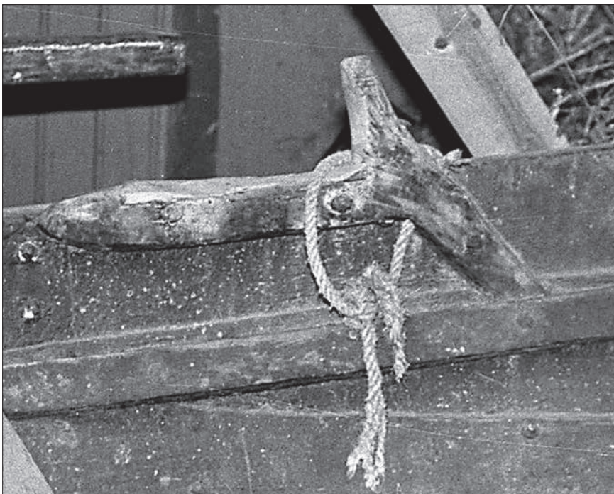
Gammaldags båtkeip laga av Bård Hegerholm ca. 1905. Det er brukt keipnavar til å lage hol for hamlebandet. Det fanst både store og små keipnavarar.
