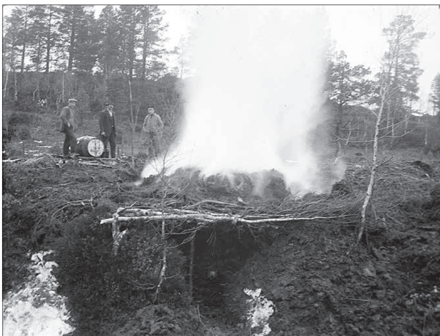
Tjørebrenning i mila på Kleive i 1930-40-åra. Varmen i mila gjer at tjøra renn ut av den feite spika og blir samla opp under mila. (Foto Peder Stokke)
