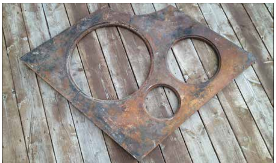
Ei rombisk århelle frå Lesja. Dei mange formene på platene tyder på at dei helst vart støypte etter mål. Eg har ikkje sett eit einaste fabrikkmerke. Omnsdørene har fabrikklogo i fleire tilfelle, m. a. Kampen støperi.
